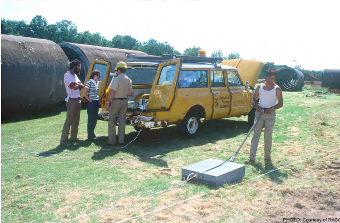
Figura 4. Geofísicos, incluido Bruce Bevan de Geosight of New Jersey y de la empresa Geophysical Survey Systems de New Hampshire, tirando de un prototipo de antena de 300 MHz capaz de "ver" a través de la capa de depósitos de superficie y relleno de lutitas que cubren el asentamiento enterrado de Raritan Landing . El equipo de radar de penetración terrestre requirió un camión para su transporte en 1978; Los sistemas modernos ahora caben en una mochila (Foto de Joel W. Grossman).
