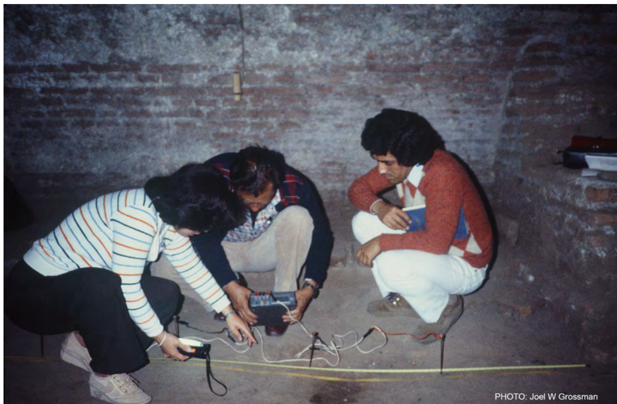
Figura 12. Arqueólogos del INC, Rolando Paredes, Graciela Fattorini y Marcelo Arroyo utilizan un moderno medidor de resistividad, Gossen Geohm 3 a batería, en uno de los pisos subterráneos de las catacumbas de múltiples cámaras del Convento de San Francisco del siglo XVI (Foto de Joel W. Grossman).
